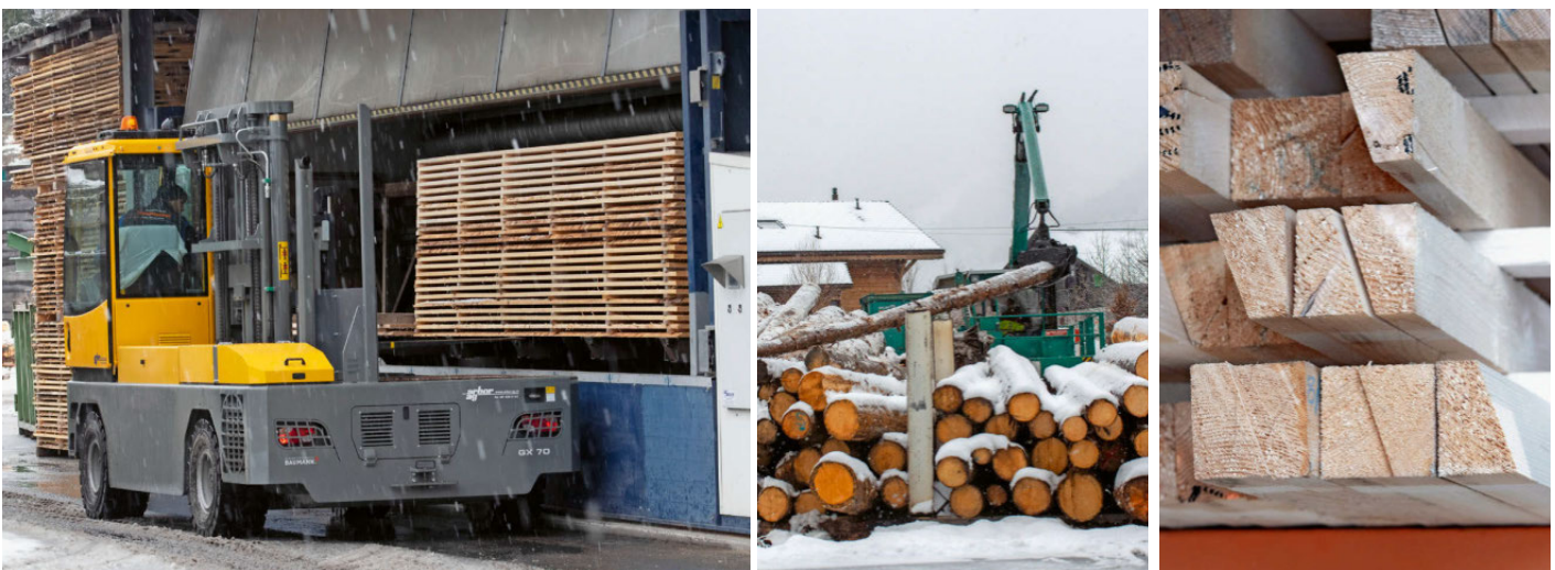
Die Imprägnierungsanlage (links) und der Rohholzplatz (Mitte) sind neben der Sägelinie die entscheidenden Einrichtungen für die Produktion hochwertiger Ware wie gehobeltes Konstruktionsholz für den Holzrahmenbau (rechts).
